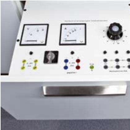
El equipo de suministro de corriente, incorporado como opción, transmite la tensión selectora predefinida por el profesor a los alumnos.
